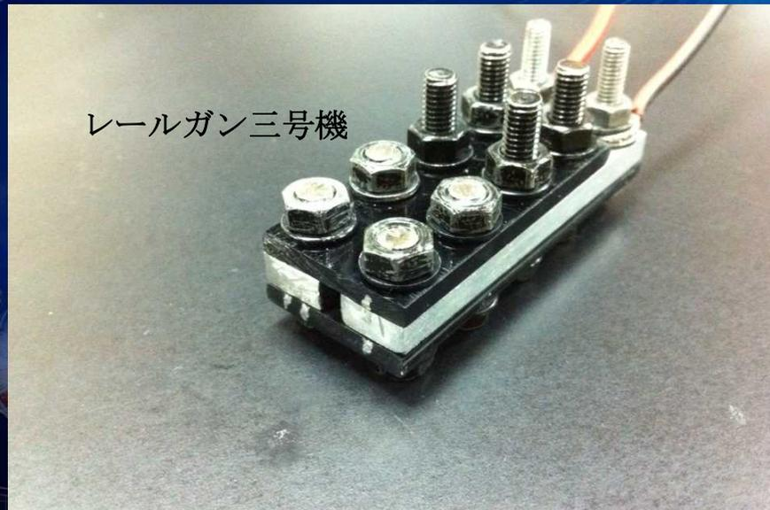
そして完成したのがこのレールガン三号機です。本体の長さはおよそ6.0cmで二号機の1/2、初号機の1/4になり、そしてボルトを増えています。もうボルトだらけです。
